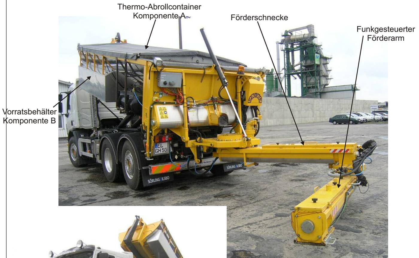
Das HUMS-Gerät (auch Sprider genannt) wird seit 1987 hergestellt. Der funkgesteuerte Förderarm hat eine Reichweite von ca. 4,6 Meter, dass entspricht einem Arbeitsbereich von 48 m<sup>2</sup>. Die Bewegungen des HUMS-Gerätes erfolgen mit Hilfe einer speziell angepassten Funkfernsteuerung.
